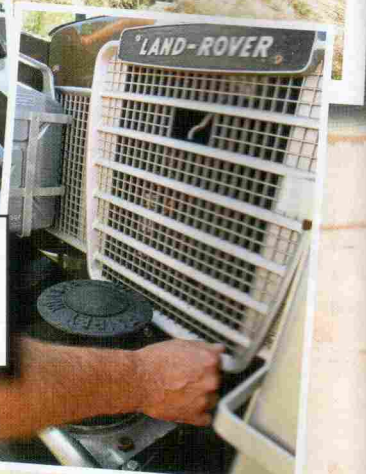
A csörlő hajtását közvetlenül a motortól kapja, egy kar segítségével lehet vele összekapcsolni
