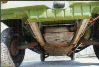
KORÁNAK ÚJSZERŰ MEGOLDÁSA A HÁTSÓ FÜGGETLEN KERÉKFELÜGGESZTÉS, A 4X4-ES VÁLTOZATNÁL IS EZT ALKALMAZTÁK
