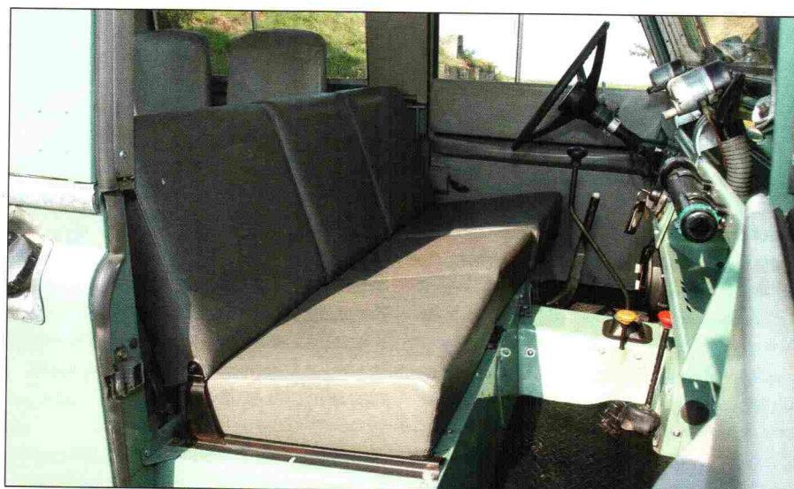
Függetlenes kézfékkar, egekbe nyúló váltókar. A kardánalagút mellett, piros fejjel a felező
